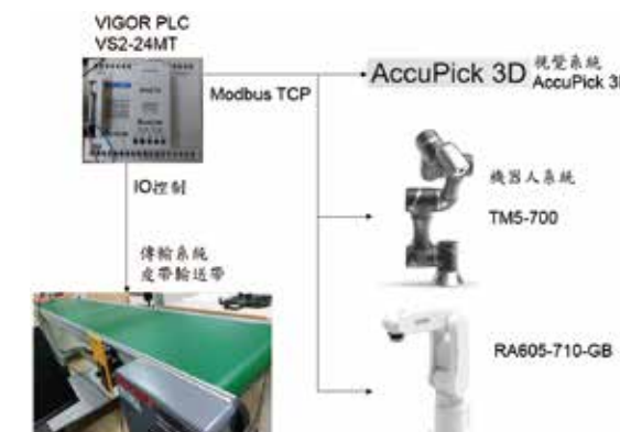
圖1.自動化檢測產線整合系統圖
