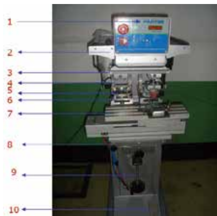
圖8.本研究之移印實驗設備
