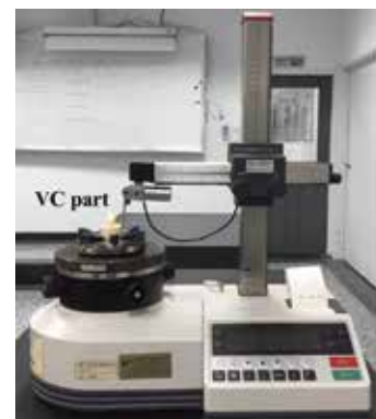
圖11.圓柱體真空注型產品真圓度之量測設備實體圖
