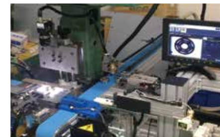
鉚接檢查機缺珠缺釘檢查
