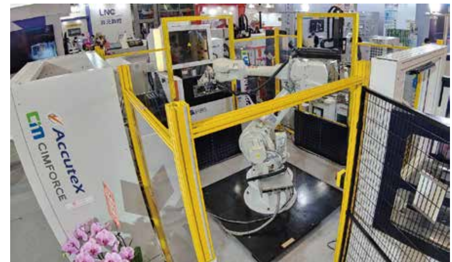
圖1. 線切割機自動化智慧製造系統工作站
