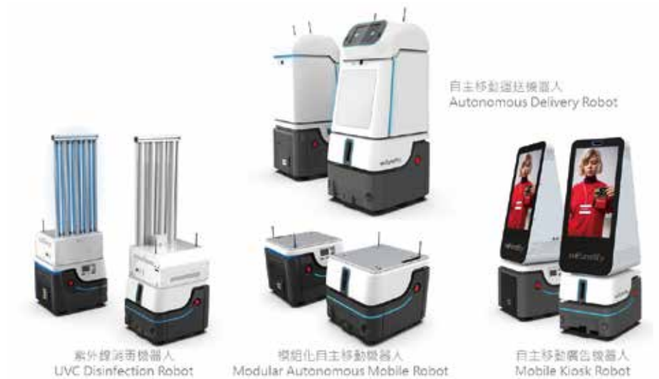
圖1. 模組化自主移動機器人及銜接相關應用模組之機器人
