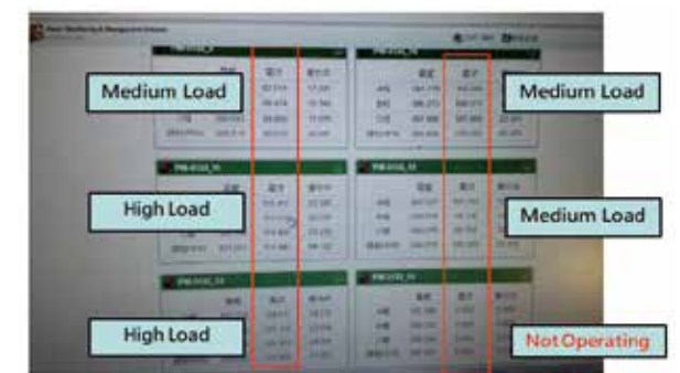
圖2. 透過視覺化了解榨油機負載狀況
