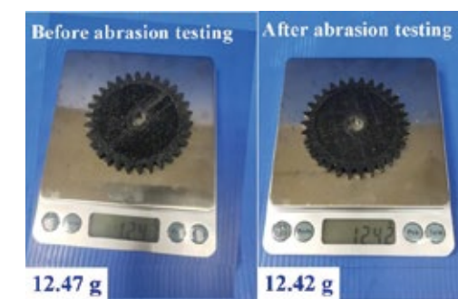
圖10.運用精密電子秤量測齒輪實驗前後重量變化之情形
