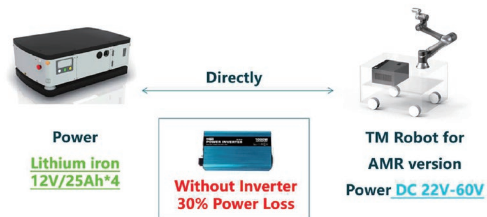
自主移動機器人(AMR)之電力供應圖
