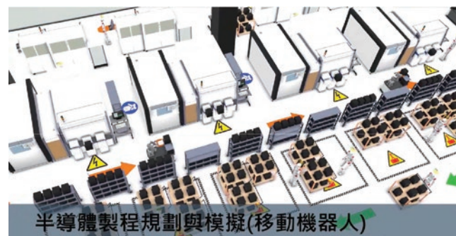
以Visual Components軟體，進行系統設計與模擬
