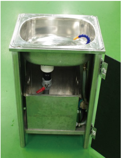
圖11.移除 PVB異型冷卻水路沖刷設備之實體圖
