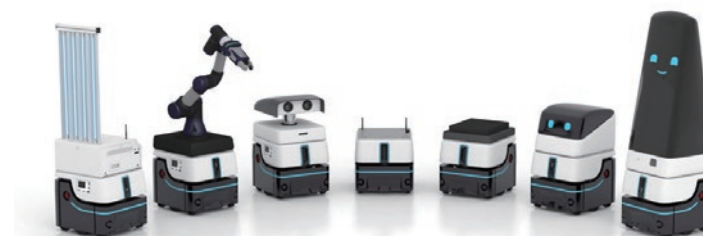
圖2. 模組化設計之自主移動機器人
