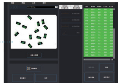
圖4. 多件多尺寸，影像自動瞬檢量測辨識與判定
