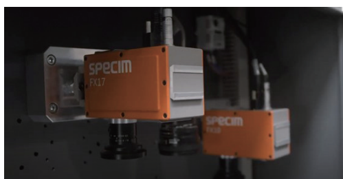
大型回收工廠：高光譜分揀系統，將高光譜分類模型匯入進行高速線上即時分揀
