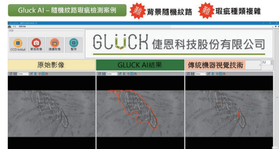
圖1. AI+AOI才能成功檢測複雜背景中的透明殘膠瑕疵
