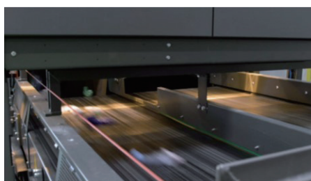
大型回收工廠：高光譜分揀系統，將高光譜分類模型匯入進行高速線上即時分揀
