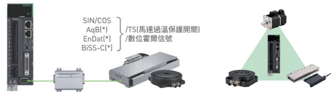
圖1. 泛用型設計可支援各式編碼器介面並搭配各種馬達
