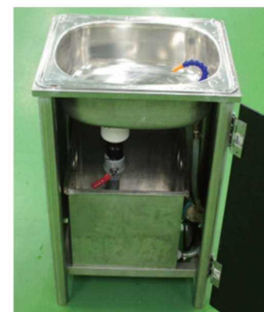
圖 6. 移除 PVB 異形冷卻水路沖刷設備之實體圖
