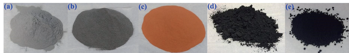
圖 1. 粉末之實體圖 (a) 鋁粉、(b) 鐵粉、(c) 銅粉、(d) 石墨粉、(e) 碳黑粉
