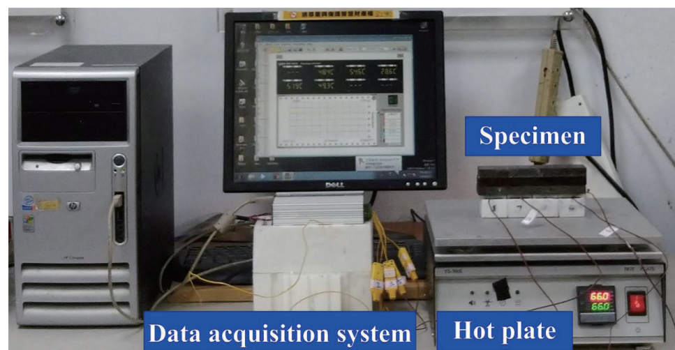
圖 7. 熱傳導係數之實際量測情形
